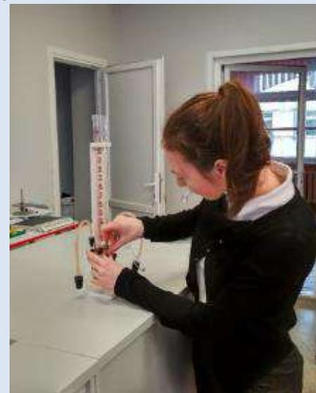
*Прибор для демонстрации зависимости скорости химических реакций от различных факторов даёт возможность экспериментально исследовать влияние на скорость химических реакций следующих факторов: природа реагирующих веществ, концентрация реагирующих веществ, площадь границы раздела фаз в гетерогенных системах (поверхность соприкосновения между реагирующими веществами), температура, катализатор, ингибитор.*
