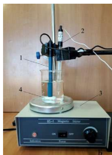
Рис. 3. Установка для определения концентрации (активности) хлорид-ионов в растворе. А: 1 — корпус датчика для определения \text{Cl}^- -ионов; 2 — разъём Micro USB для подключения к компьютеру; 3 — разъём BNC для подключения рабочего электрода; 4 — разъём для подключения электрода сравнения; Б: 1 — ионоселективный электрод (рабочий электрод); 2 — электрод сравнения (хлорсеребряный электрод); 3 — магнитная мешалка; 4 — якорь магнитной мешалки
