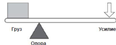
В рычагах первого рода точка опоры расположена между точками приложения усилия и нагрузки. Наиболее распространенными примерами рычага первого рода являются пила, лом, плоскогубцы и ножницы.
