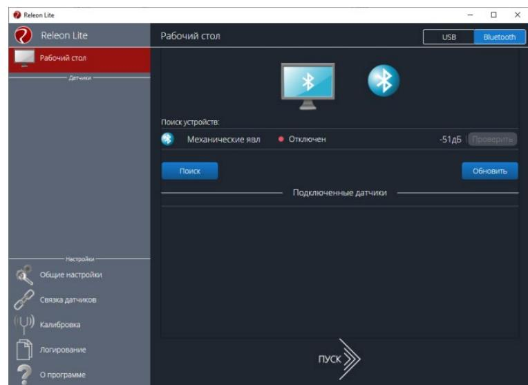
В блоке «Поиск устройств» появится ваше устройство (повторите поиск, если устройство не появилось в течение некоторого времени). Обратите внимание, у каждого датчика подключаемого по «Bluetooth» есть свой идентификационный номер, который указан на корпусе датчика и отображается в программе, в блоке «Поиск устройств» после наименования мультидатчика.
