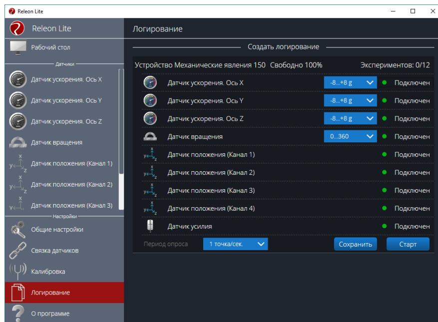
При необходимости датчики, которые не будут использоваться в эксперименте, можно отключить. И задать «Период опроса». Нажатием кнопки «Старт» датчик сам перейдет в режим «логирования» и начнет сбор данных. По завершению эксперимента, выгрузка данных осуществляется тем же способом, как и при включении режима «логирования» без компьютера.
