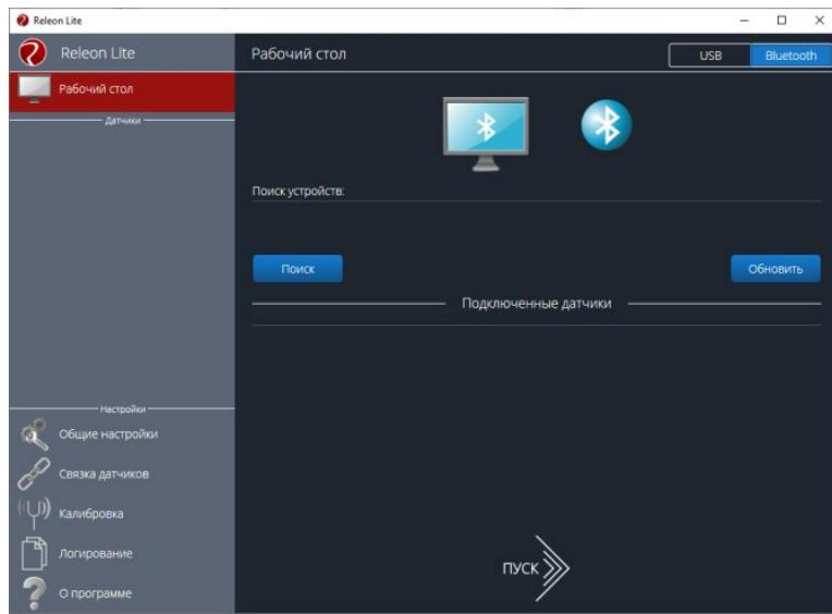
Нажмите кнопку «Поиск». Если модуль подключения «Bluetooth» не подключен к компьютеру, то кнопка «Поиск» не активна и имеет серый цвет (рекомендуется использовать модуль из комплекта ЦЛ, встроенный модуль может не удовлетворять техническим требованиям).
