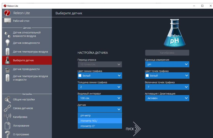
Для переключения режима выберите требуемый пункт в списке "Диапазонов" и подключите необходимый щуп. При работе следует помешивать раствор электродом. В конце работы следует промыть и высушить электрод. Электрод следует хранить в буферном растворе.
