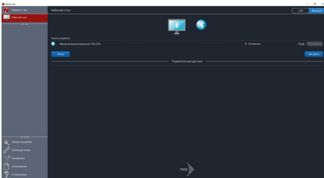
Завершите подключение мультидатчика путем нажатия на кнопку «Отключен», которая изменит свое значение на «Подключен». Как только устройство будет подключено, датчики, входящие в его состав, отобразятся в списке «Подключенные датчики».
