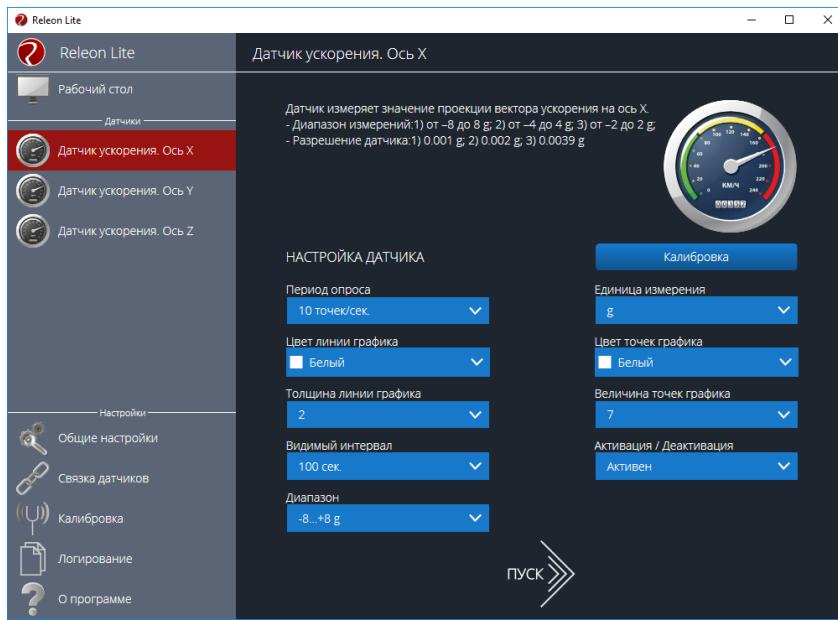
Подключите датчик ускорения к программе Releon Lite. Перейдите на вкладки датчика ускорения (Ось X, Ось Y, Ось Z).
