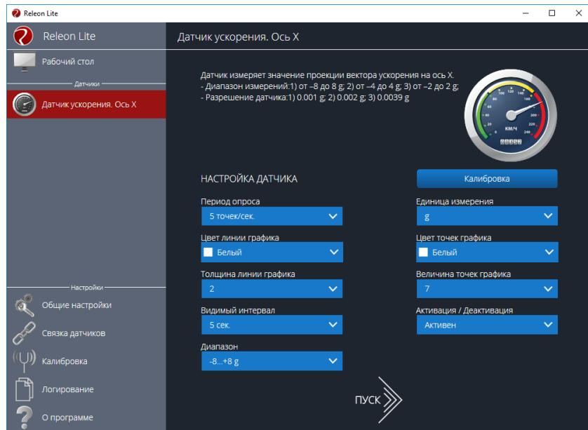
Единицы измерения датчика – g (ускорение свободного падения, округленное до 10 м/с<sup>2</sup>). Не забывайте делать перевод ускорения для расчетов в м/с<sup>2</sup>.
