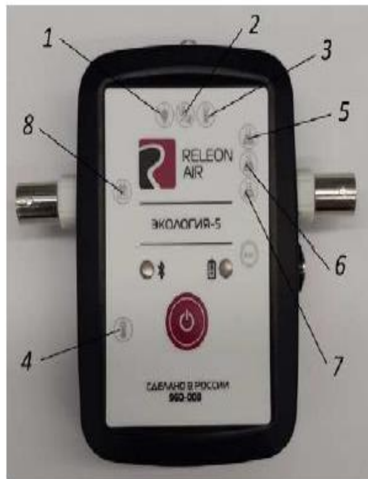
Рис. 2. Мультидатчик по экологии. Обозначение разъёмов и технологических отверстий: 1 — освещённость, 2 — относительная влажность воздуха, 3 — температура окружающей среды, 4 — температура растворов, 5 — нитрат-ионы, 6 — хлорид-ионы, 7 — pH, 8 — электропроводность
